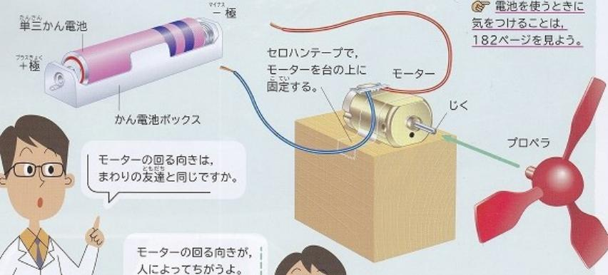
回路ができると、かん電池の+極からモーターを通して-極に電気が流れ、モーターが回ります。この電気の流れを電流といいます。
